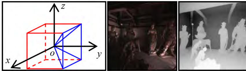
图 4.5: (a) 用于地面视角图像合成的虚拟立方体示意图，其中蓝色棱锥表示其中的一个虚拟相机。(b) 一个地面视角合成图像示例。(c) 图像 (b) 的深度图。
