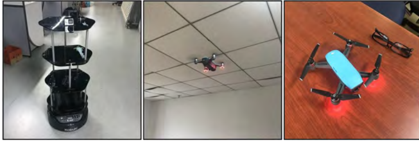
图 5.13: 本章实验中用到的元数据采集设备。从左到右：机器人上的 TurtleBot，空中的 DJI Spark，桌面上的 DJI Spark。
