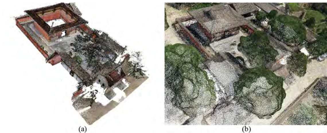
图 2.1: 由不同来源的图像重建得到的模型（稠密点云）。(a) 地面模型。(b) 航拍模型。 Figure 2.1: The reconstructed models (dense point clouds) from different image collections. (a) The ground model. (b) The aerial model.
